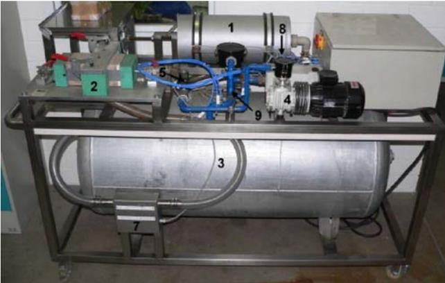
Bild 3. Prüfstand zur Druckverlaufs- und Luftmengenmessung
