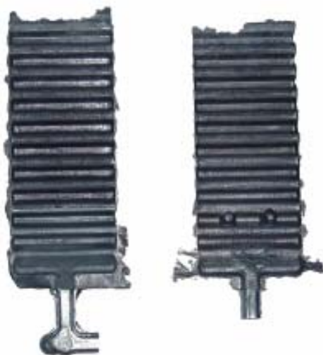
Bild 10. Links „mit“, rechts „ohne“ Verschleissersatz aus Wolfram
