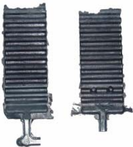
Bild 10. Links „mit“, rechts „ohne“ Verschleissinsert aus Wolfram
